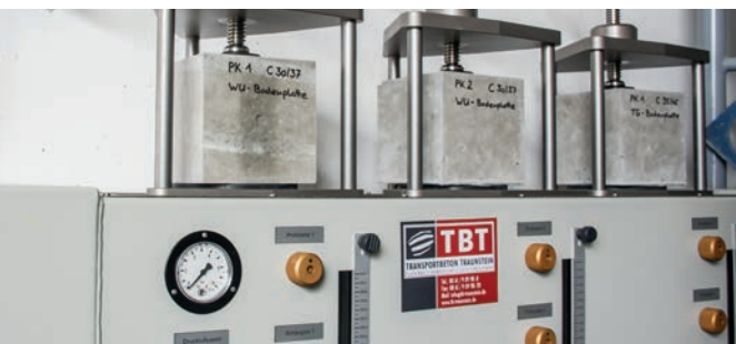
Prüfvorrichtung zum Aufbauen von Wasserdruck, DIN EN 12390-8
